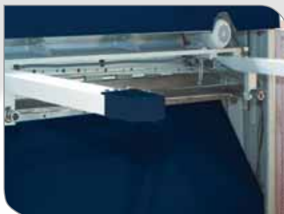
• Light Curtains for Finger Protection • Lichtschrank für Fingerschutz • Световой барьер защиты пальцев
